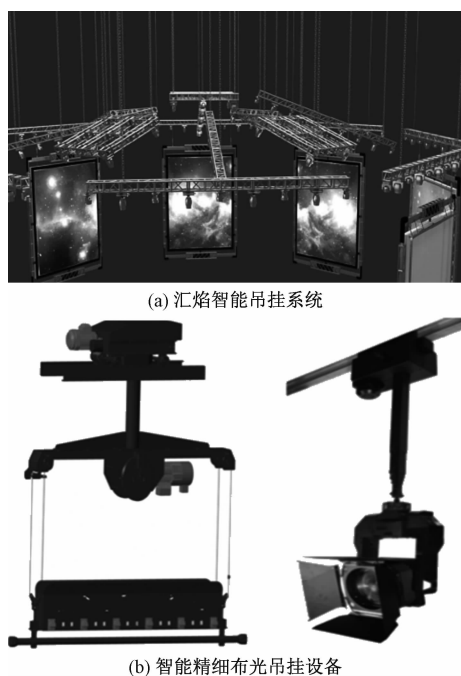
图 7 灯光吊挂系统示例
